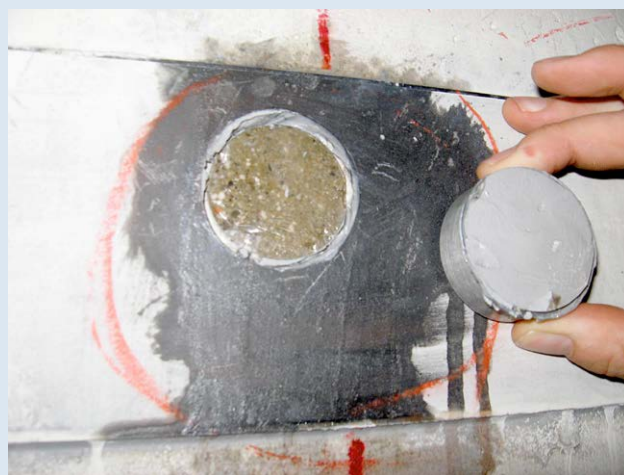
Sliki 27 in 28: Med odtržnim preizkusom se mora stik porušiti po osnovnem materialu (levo), in ne po lepilu (desno).
