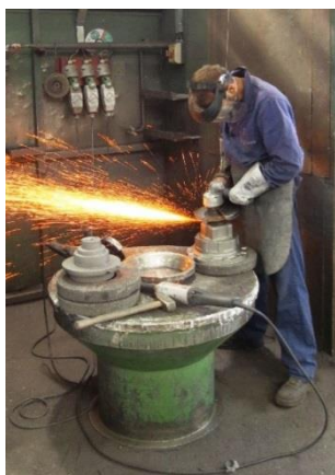
Slika 7: Opravljanje dela s kotno brusilko
